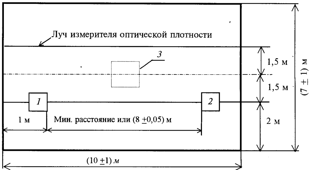
Схема расположения ИПДЛ и контрольно-измерительной аппаратуры при проведении огневых испытаний:
