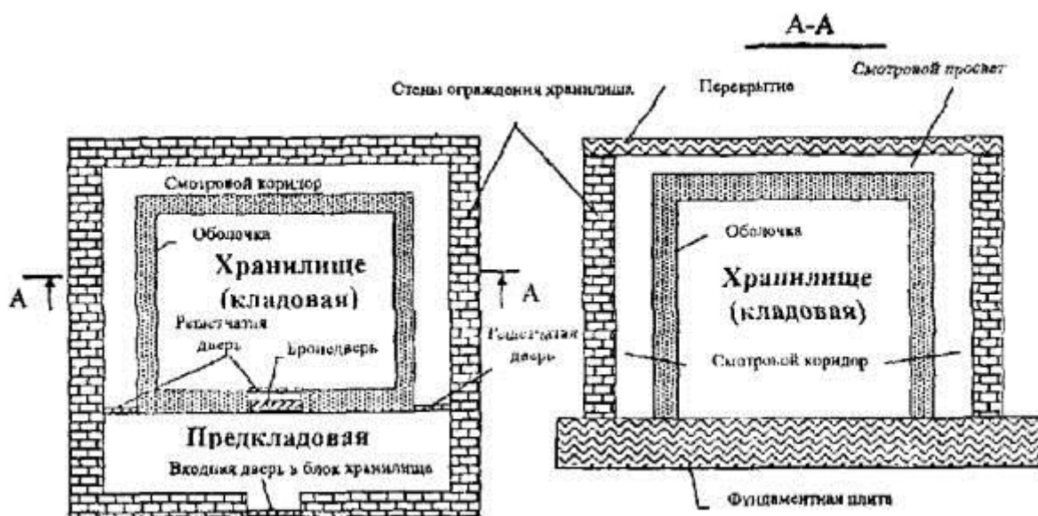
Рисунок П8.1 - Схематичное устройство хранилища ценностей
